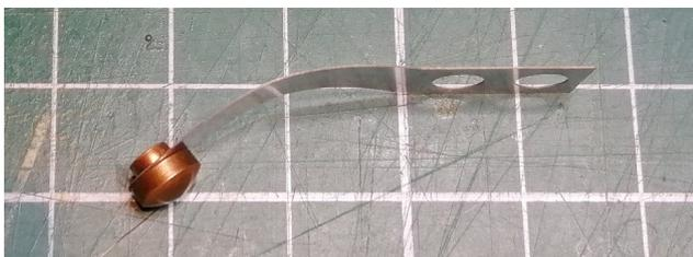
Das jetzt entnommene Federblech biegt man (am einfachsten über den Finger) in einem Bogen von Befestigungspunkt bis dem Abgriffkontakt weiter nach unten. So wird wieder ausreichend Druck aufgebaut.
